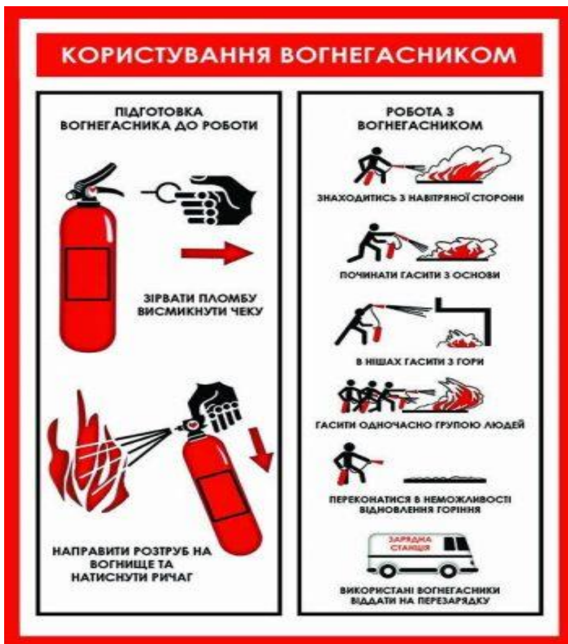
Рис. 1 Схема користування вогнегасником (зображення взято з інтернет ресурсу: https://ukrainska-gromada.gov.ua/rv-gu-dsns/pravy-la-korystuvannya-ta-ekspluataczii-vognegasnykamy.html ).
